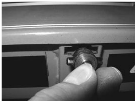
Schuif de 2 assen met schroefdraad en pen in de voorziene openingen
