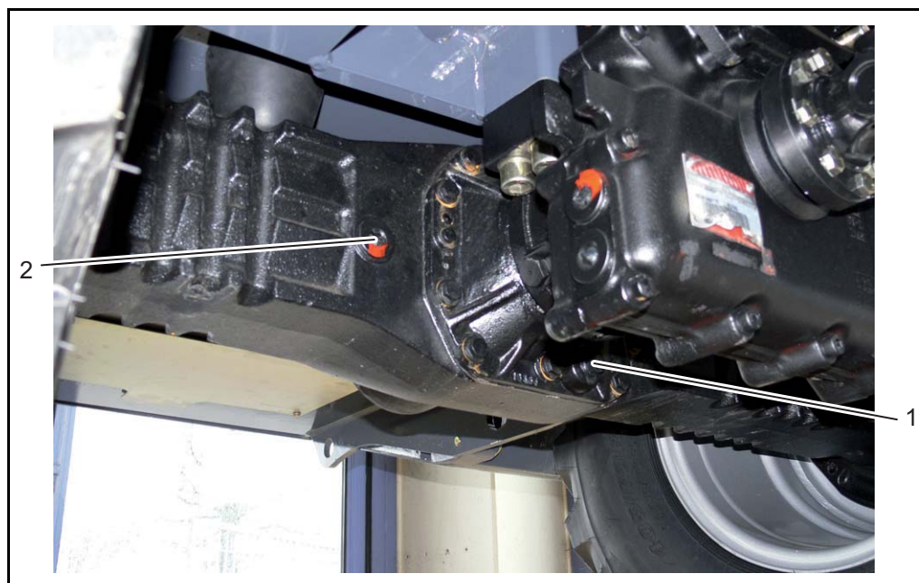
Afbeelding 6-26 Differentieel van de achteras
