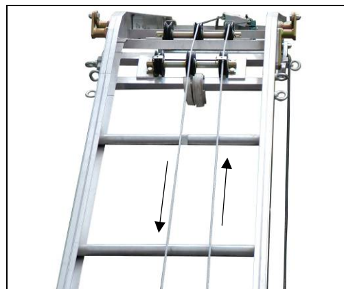
Fig. 37 Kabelgeleiding over het knikstuk
