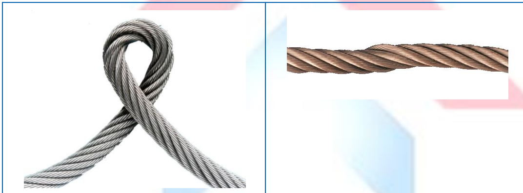
Afb. 4-10 Kink (rechts) en de vervorming van kabel door een kink (rechts)
