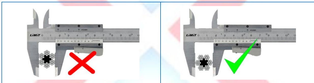
Afb. 4-3 Meet een staalkabel altijd over de grootste diameter
