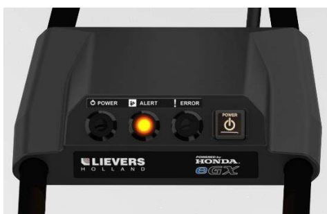
Figuur 23 Alarmmelding accu motor.
