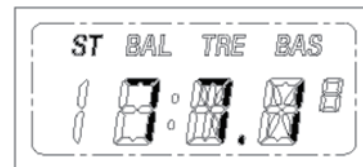
Frequentie weergave (Automatisch zoeken is gestopt. Als stereogeluid is ontvangen, wordt "ST" afbeelding aangezet)
