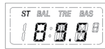
Frequentie weergave (Automatisch zoeken is gestopt. Als stereogeluid is ontvangen, wordt "ST" afbeelding aangezet)
