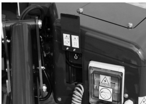
Fig. 115 Aansluitdoos in ruimte met elektrische componenten.
