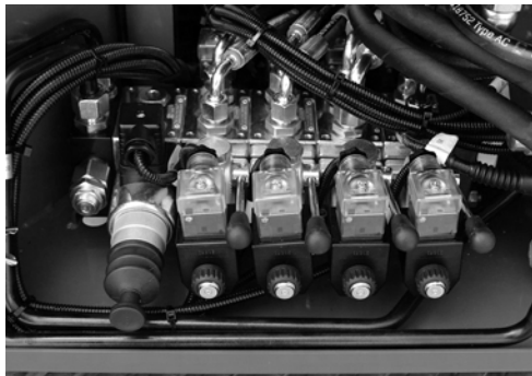
Fig. 75 Bedieningen op verdeler links
