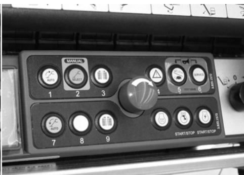
Fig. 61 Noodstop op de afstandsbediening
