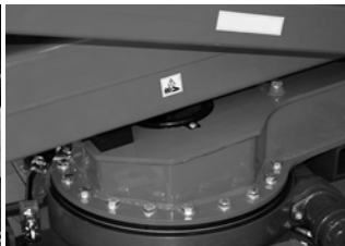
Fig. 97 Afknelpgevaar op machine 2
