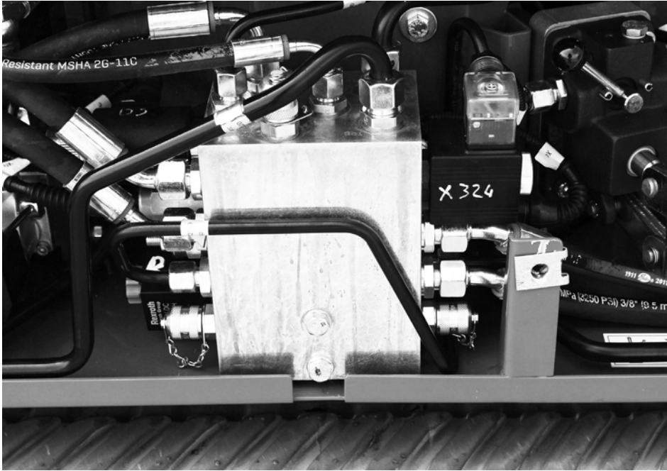
Fig. 167 Drukaansluitingen op de machine
