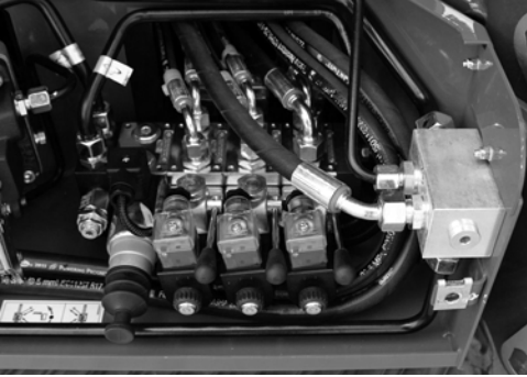
Fig. 141 Voorbeeld bedieningen op verdelers
