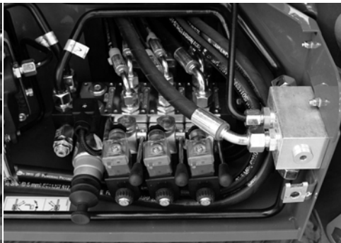
Fig. 76 Bedieningen op verdeler rechts
