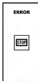
Fig. 80 Fout, u heeft geprobeerd de machine met ingedrukte stopknop in te schakelen
