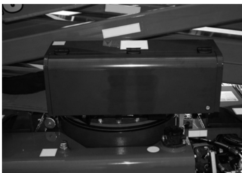
Fig. 123 Beschermkap verdeler hoogwerkerdeel
