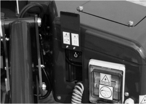
Fig. 131 Aansluitdoos in ruimte met elektrische componenten.
