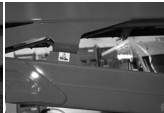
Fig. 98 Afknelpgevaar op machine 3
