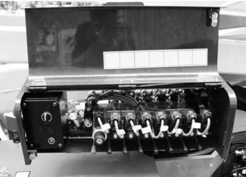
Fig. 125 Bedieningen op verdeler
