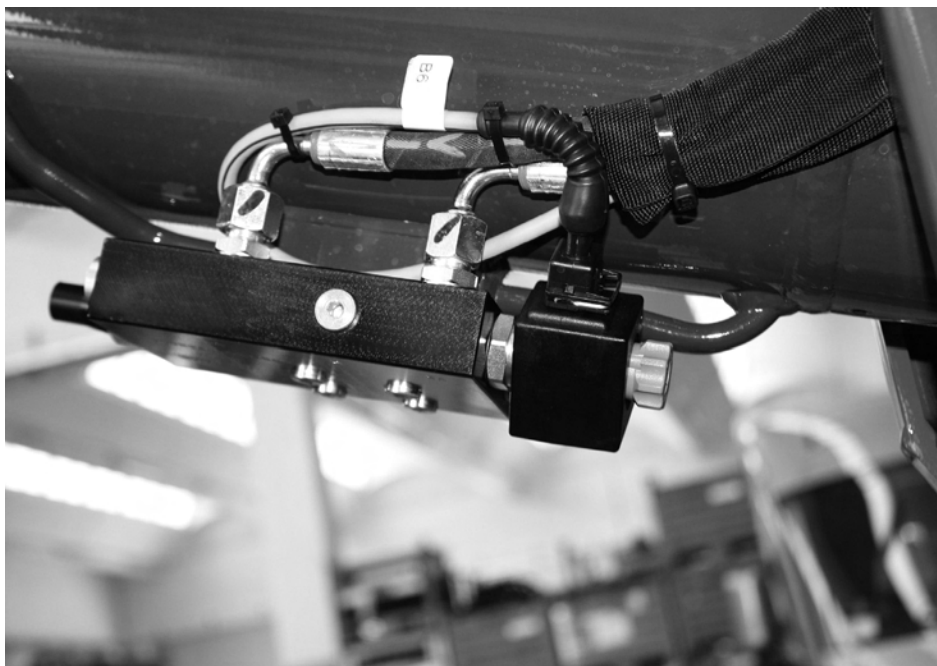
Fig. 66 Elektrokleppen voor de nooddaling wegens ernstige situatie
