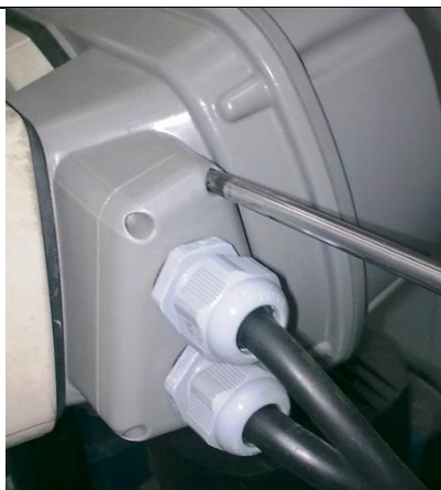
Open de zijdeksel (4 schroeven)
