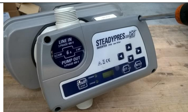
Open de voorkant deksel met 4 schroeven
