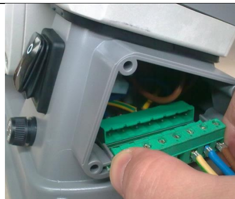
Steek de stekker in de connector en sluit het zijdeksel.
