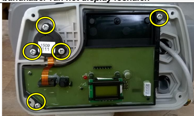
Verwijder eerst de DRUK SENSOR en dan het CONTROL BOARD door het losschroeven van de 5 aangegeven schroeven
