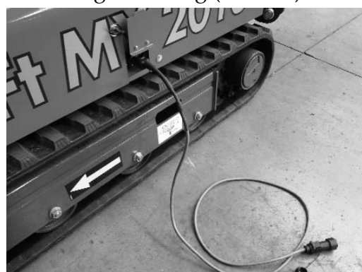
CONNETTORE SECONDO TELECOMANDO OPTIONAL
