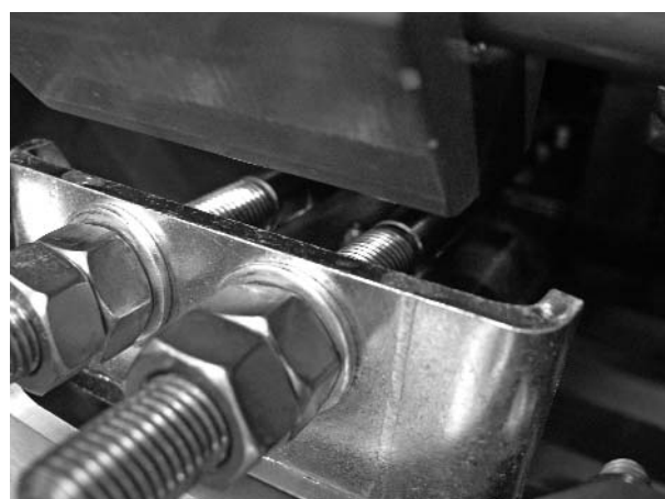
KOORDUITEINDE MET ZITTING VOOR SLEUTEL BELEMMERING ROTATIE
