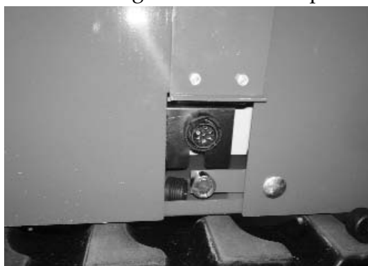
POSIZIONE CONNETTORE SECONDO TELECOMANDO OPTIONAL
